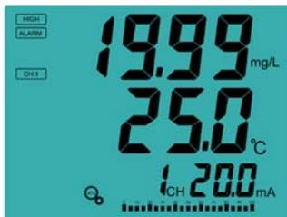
계기의 사용 중 온도 편차가 심하거나 측정이 안될 때 우선 센서의 T,T단자의 저항값을 멀티테스터로 측정하여 1,000~1,391ohm 사이가 나오면 온도센서는 이상이 없는 것이고, 내부 설정이 틀어진 것으로 계기의 T,T단자에 표준저항박스로 1,000ohm을 넣는다.
